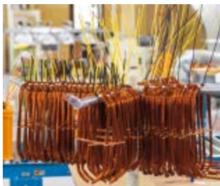
巻かれた銅線にはゆがみは許されない
