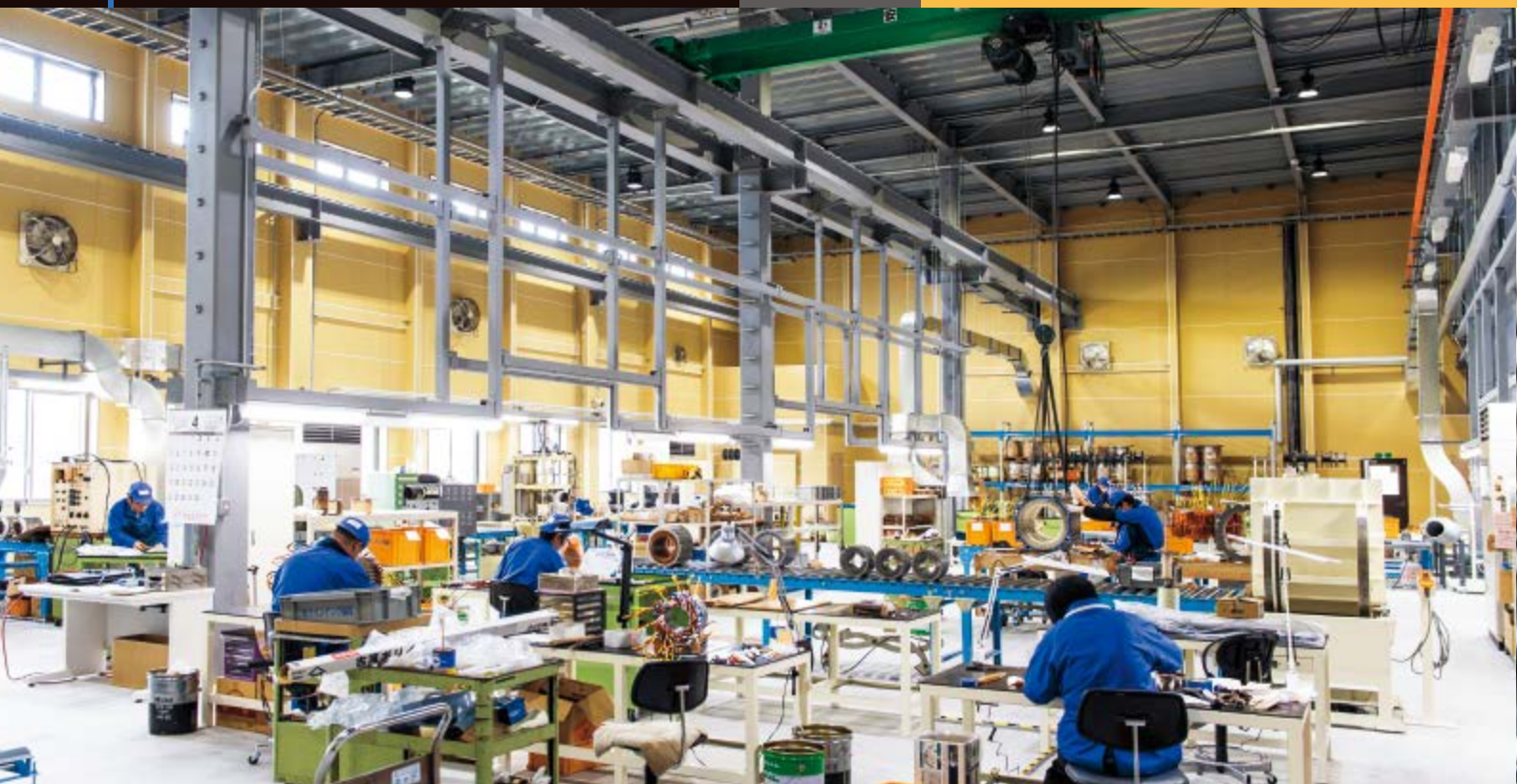
将来の発展を考慮して旧工場の天井高よりも3mも高くした新工場の建屋
